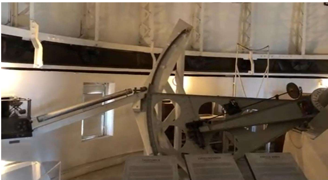
Teleskopmekanismen, med sentrifugalregulatoren i «boksen» til venstre i bildet.
