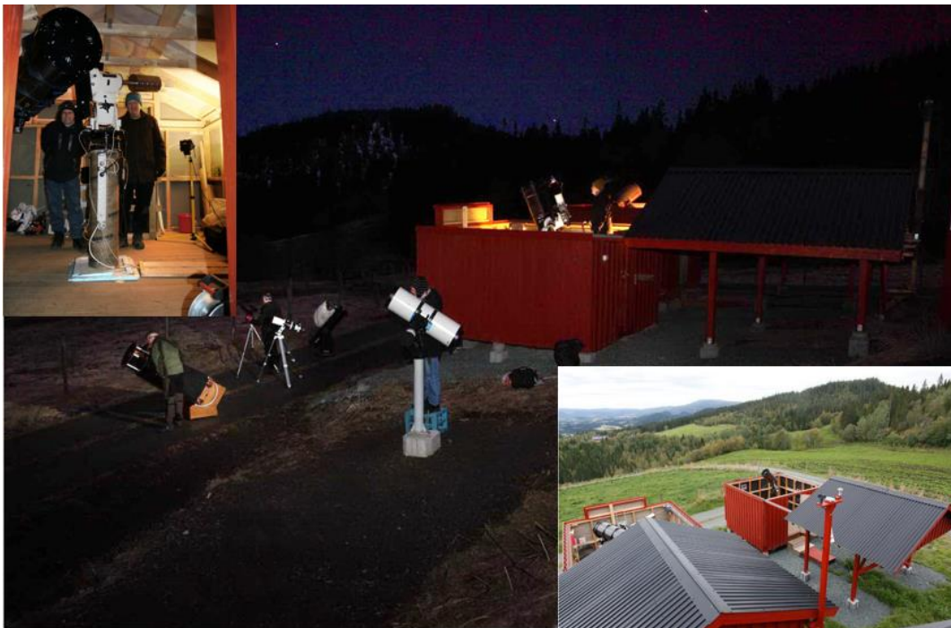
Figur 12: Oversikt over observatoriekomplekset på Rossmo. Det visuelle observatoriet til høyre på dagslysbildet og bakerst på nattbildet. Ekstra teleskoper kan monteres på faste søyler eller settes fritt ute i området etter behov. Oppe til venstre ser vi inn døra til fotoobservatoriet med 16 tommer astrografen til Erlend Rønnekleiv på Astro-Physics monteringa til Birger Andresen.
